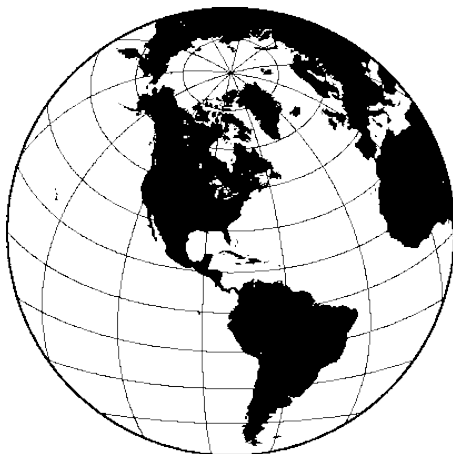
Figura: Ejemplo de la utilización de la proyección azimutal de Lambert aplicado a un continente.
