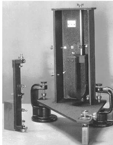
Note que en la era digital de hoy los instrumentos pueden registrar los movimientos y los transcribe en un disco duro, así que sismómetro/sismógrafo sirven igual. Acá vemos el interior de un sismómetro Güralp de tres componentes, y una comparación con un sismómetro Wood-Anderson de ~1930.
